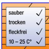
Nach vollständiger Austrocknung wird der saubere Belag weiterbehandelt. Eine kleine Testfläche an unauffälliger Stelle zeigt das spätere Ergebnis und den Verbrauch. Insbesondere werkseitig vorbehandelte Fliesen müssen auf die Eignung der vorgesehenen Produkte vorher geprüft werden.
